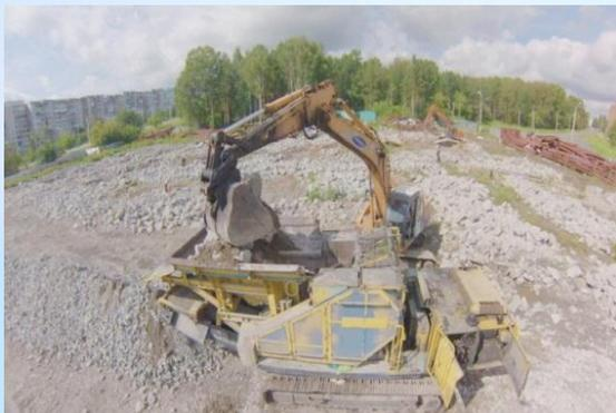
Экологический региональный центр эксплуатирует мобильный дробильно-сортировочный комплекс по переработке отходов от строительства и сноса зданий и сооружений
